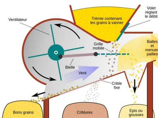
Cette machine sert à vanner le blé et à nettoyer le grain récupéré sous la batteuse. Son fonctionnement est basé sur la différence de poids et de volume des bons grains et des corps étrangers qui s'y trouvent.
